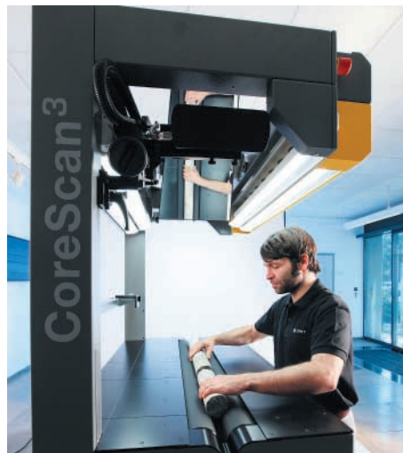
Rys. 2 Pracownik firmy DMT w trakcie skanowania rdzenia (źródło http://www.dmt-group.com ).
